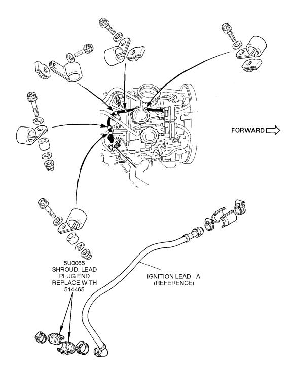
LOCATION OF SHROUD, LEAD PLUG END ON IGNITION LEAD — A 74-21-43-01 FIGURE 1
