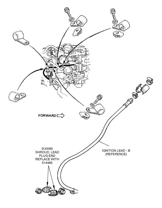
LOCATION OF SHROUD, LEAD PLUG END ON IGNITION LEAD — B 74-21-43-02 FIGURE 2
