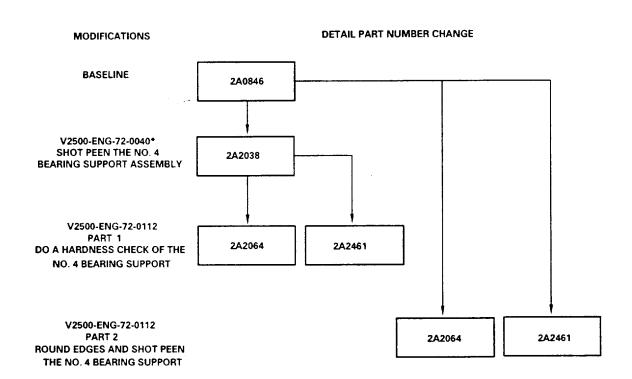
THIS CONFIGURATION IS ONLY GIVEN FOR THE RECORD. THIS SERVICE BULLETIN IS SUPERSEDED BY V2500-ENG-72-0112. FOR FUTURE MODIFICATIOS THAT ARE NECESSARY DO THE PROCEDURES GIVEN IN V2500-ENG-72-0112.
