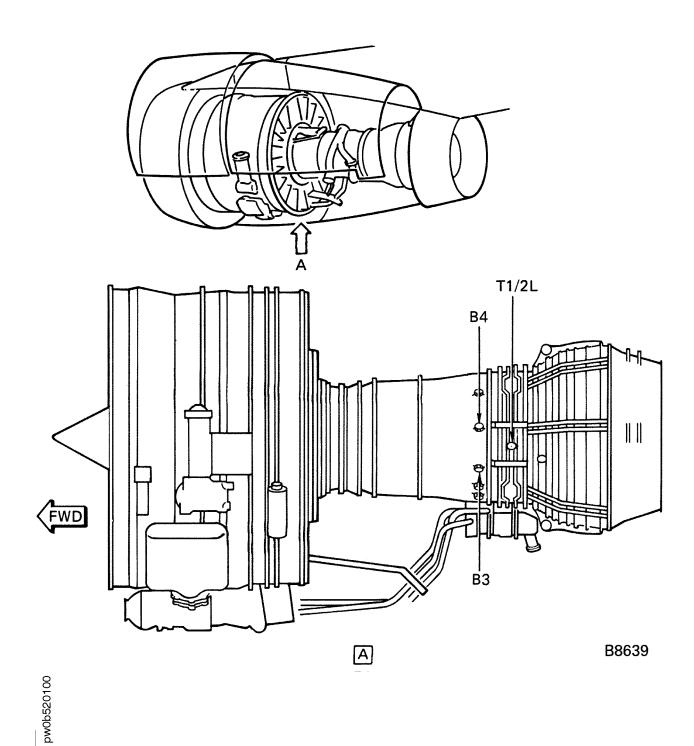
HP TURBINE BORESCOPE LOCATION FOR INSPECTION OF THE STAGE 1
