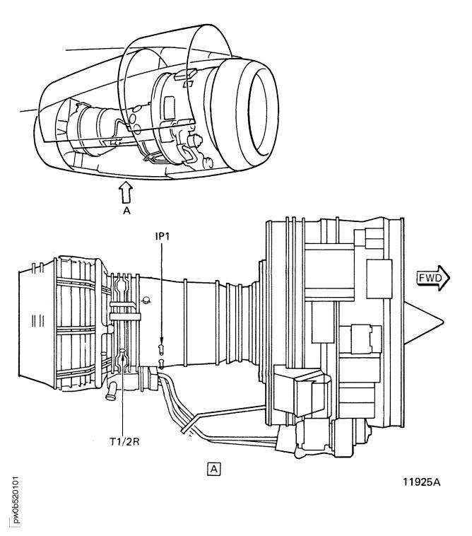
HP TURBINE BORESCOPE LOCATION FOR INSPECTION OF THE STAGE 1
