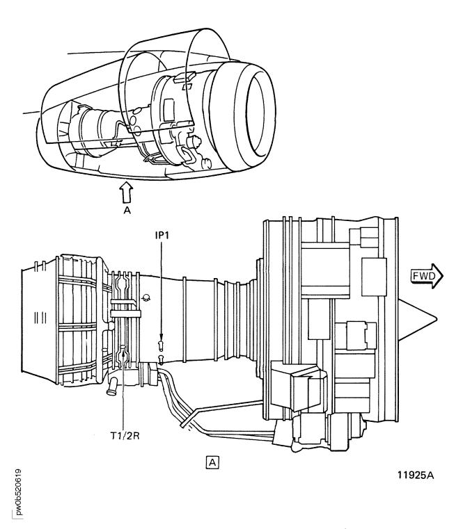
HP TURBINE BORESCOPE LOCATION FOR INSPECTION OF THE STAGE 1 HPT DUCT SEGMENTS (RIGHT SIDE)
