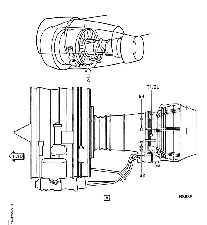
HP TURBINE BORESCOPE LOCATION FOR INSPECTION OF THE STAGE 1 HPT DUCT SEGMENTS (LEFT SIDE)
