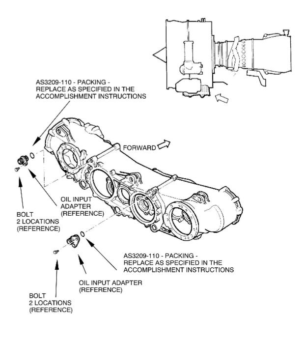
LOCATION OF PACKING (TUBE 182 AND TUBE 183) FIGURE 6
